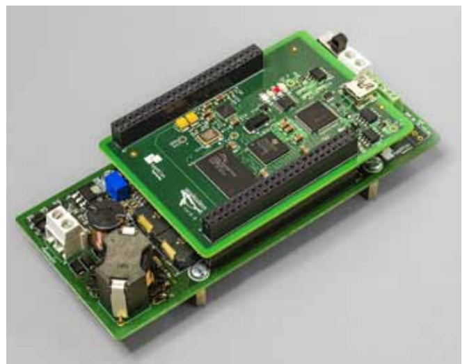
SeaModem, modem per applicazioni sottomarine sviluppato da Applicon
