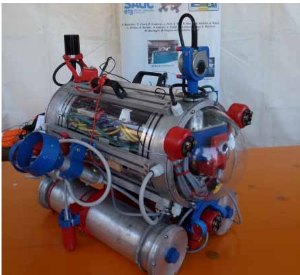
FeelHippo il robot subacqueo dell'Università di Firenze equipaggiato con il SeaModem di AppliCon
